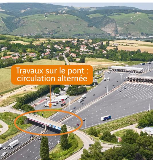
Dans un premier temps, côté nord de l'ouvrage, les dispositifs existants seront démontés et remplacés temporairement pour permettre des interventions sur l'étanchéité, la chaussée, et l'installation des dispositifs de retenue définitifs.
